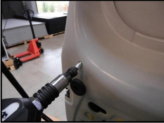
**Etape 38** : Retirer le guide tringle haut puis placer les 3 inserts M6 (pour modèle Trafic II) et 1 insert (pour modèle Trafic III)
