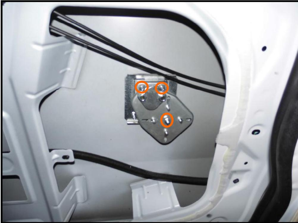
**Etape 7** : Percer  $\varnothing 13$  et insérer un passe fil
