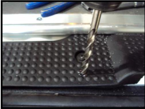
**Etape 22** : Percer le marche pied Ø11 sur l'empreinte laissée par la graisse
