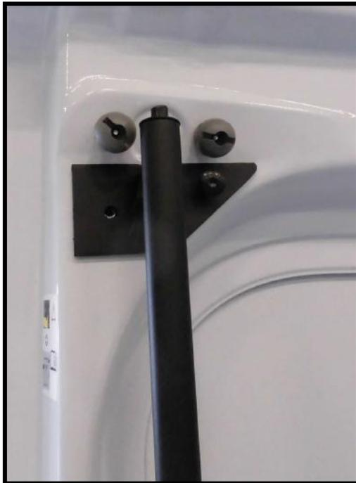
**Etape 36 (modèle Trafic III) : Fixer le tube à l'aide des fixations d'origine du verrou**
