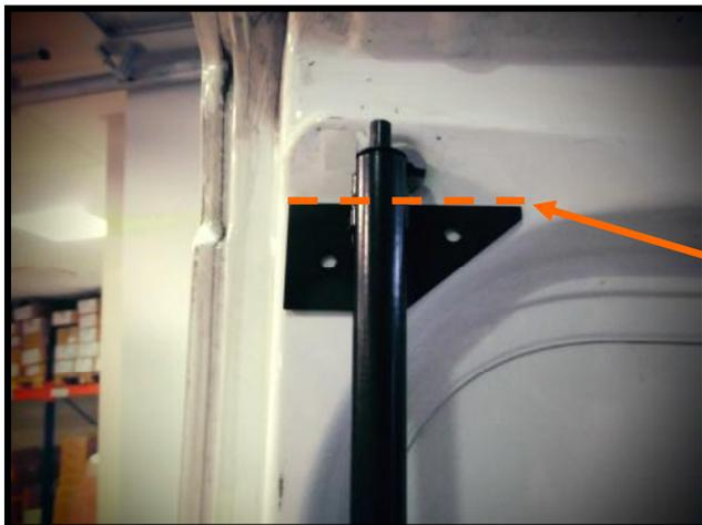
**Etape 33 (modèle Trafic II, Vivaro II et Primastar II)** : Mettre en place le guide tringle haut sous le **bossage**
