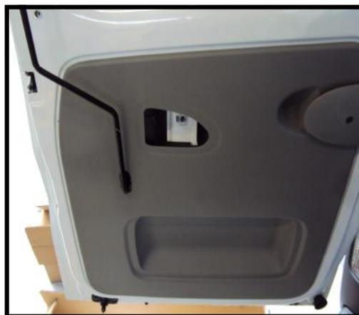
**Etape 49 (modèle Trafic II, Trafic III, Vivaro II et Primastar II (L1 H2, L2 H2) :** Fixation du guide tringle haute, partie haute. Refixer avec la vis d'origine
