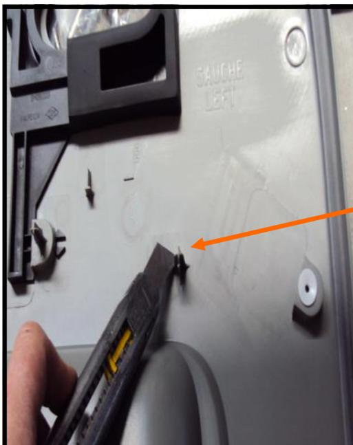
**Etape 46 (modèle Trafic II, Trafic III, Vivaro II et Primastar II (L1 H2, L2 H2)) :** Découper le guide étoile plastique avec un cutter
