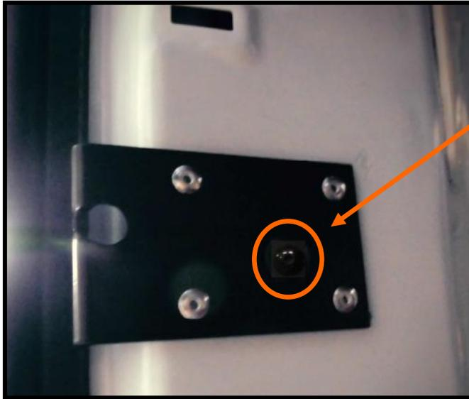
**Etape 43 (modèle Trafic II, Vivaro II et Primastar II)** : Pour la fixation de la gâche haute rester à l'intérieur du véhicule, fermer les deux portes, placer la gâche haute en face de la tringle et fixer la avec **4 rivets pop**
