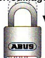
7. Appuyer sur l'anse. Le mécanisme s'enclenche et le cadenas est verrouillé
