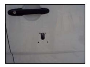
Après avoir serré les tiges filetées sur le cache mul-t-lock,inserer Celui-ci sur la portière avec son joint et placer le support serrure.
