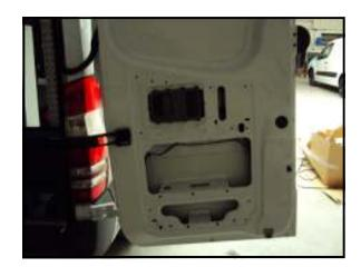
Placer le gabarit de perçage suivant les cotes indiquées.
