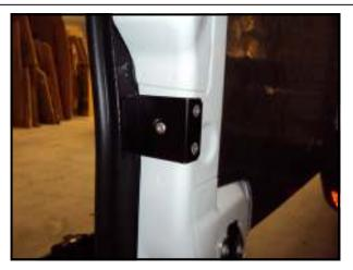
Mise en position de la tringle basse . Percer un trou diam 13 + passe fil suivant la cote indiquée le plus prés possible de l'extérieur de la porte.
