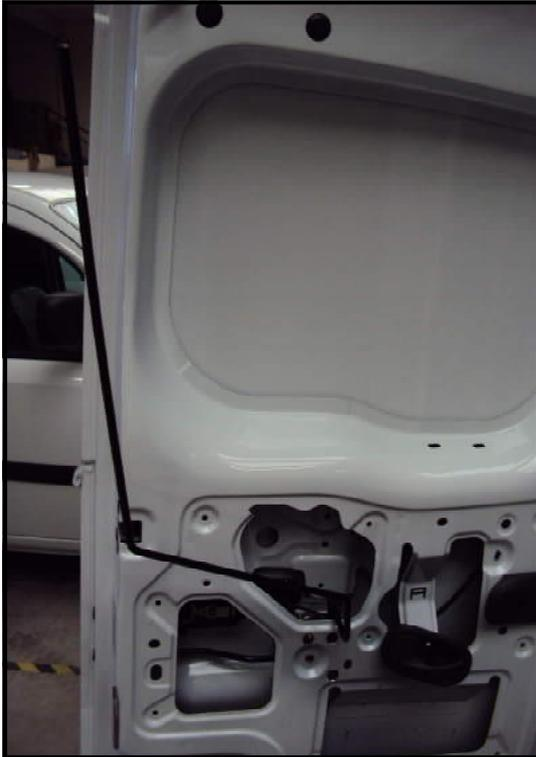
**Etape 12** : Positionner le guide tringle haute puis tracer les 2 trous Ø7
