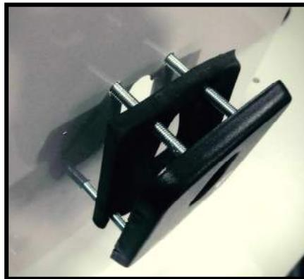
**Etape 5 :** Mettre en place le support serrure puis le fixer avec 1 écrou M6
