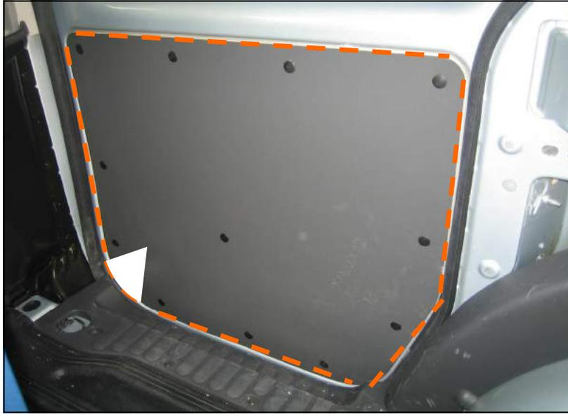
**Etape 2** : Positionner le gabarit de perçage suivant les cotes indiquées
