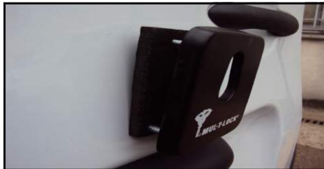
**Etape 5 :** Mettre en place le support serrure puis le fixer avec 1 écrous M6
