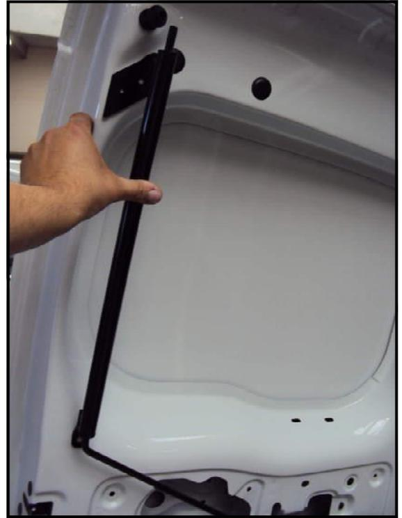
**Etape 13** : Apres avoir retiré le guide tringle, percer les **2 trous Ø9** et placer les inserts M6
