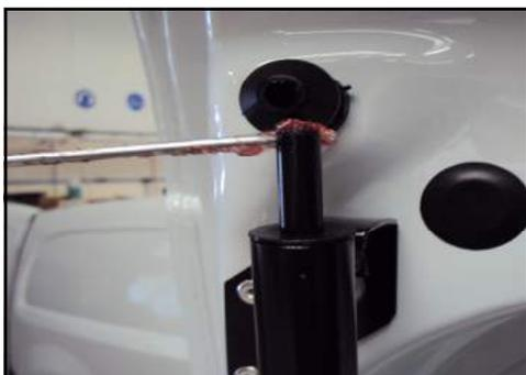
**Etape 18 :** Ajouter de la graisse sur la partie haute de la tringle
