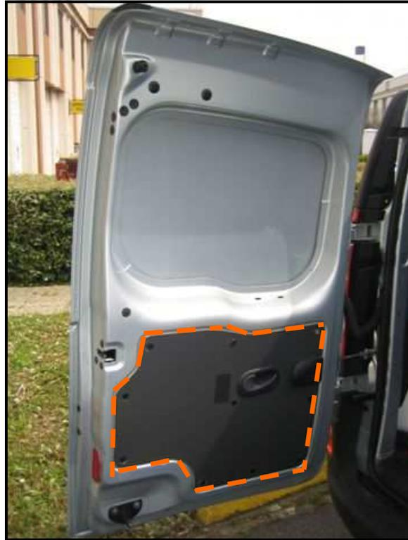
**Etape 1 :** Retirer soigneusement la **garniture** de la porte arrière afin de pouvoir placer le mécanisme du Kit 3 Points.
