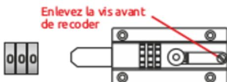
1. Le boulon est réglé en usine sur 000. Avant de pouvoir recoder le CombiBolt3 vous devez retirer la vis indiquée dans le schéma ci-dessus.
