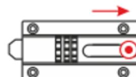
2. Une fois que la vis a été retirée, visez le bolon jusqu'à sa position d'arrêt. Soulevez le bouton de verrou et reculez jusqu'à une seconde position d'arrêt. Poussez-le vers le bas pour le verrouiller dans la position recodage.
