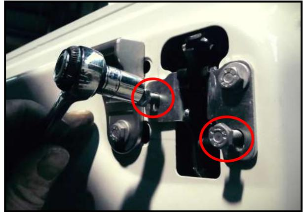
*Fixation de la partie haute* : Placer le guide tringle haut et visser avec les vis d'origine.
