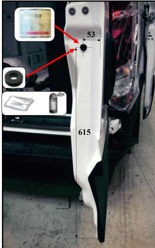
Placer une **étoile anti-vibration** sur la tringle latérale. Puis fixer celle-ci à l'aide d'un écrou M5
