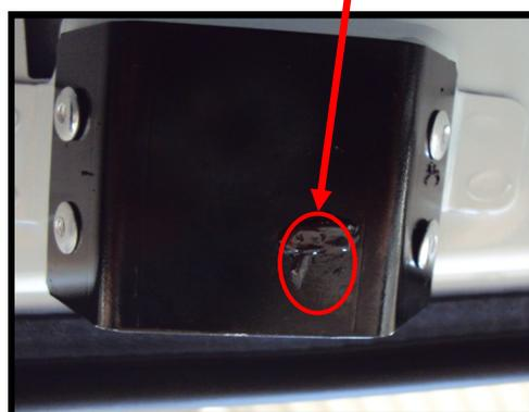
Percer Ø11 sur la gâche haute sur l'empreinte laissée par la graisse.
