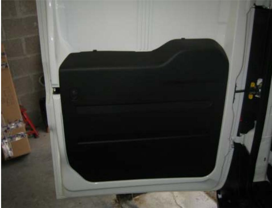
1-2. Retirer soigneusement la **garniture** de la porte arrière afin de pouvoir placer le mécanisme du Kit 3 Points.
