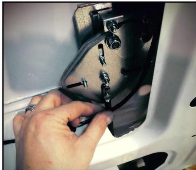
Lorsque la tringle basse est positionnée, fixer un peu de **graisse** à son extrémité. Cette graisse servira à laisser une empreinte sur le châssis du véhicule. Fermer la porte, actionner la serrure : l'empreinte est réalisée.
