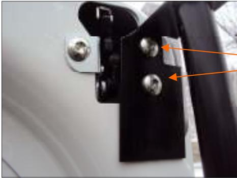
Placer le guide tringle haut en revissant les deux vis.
